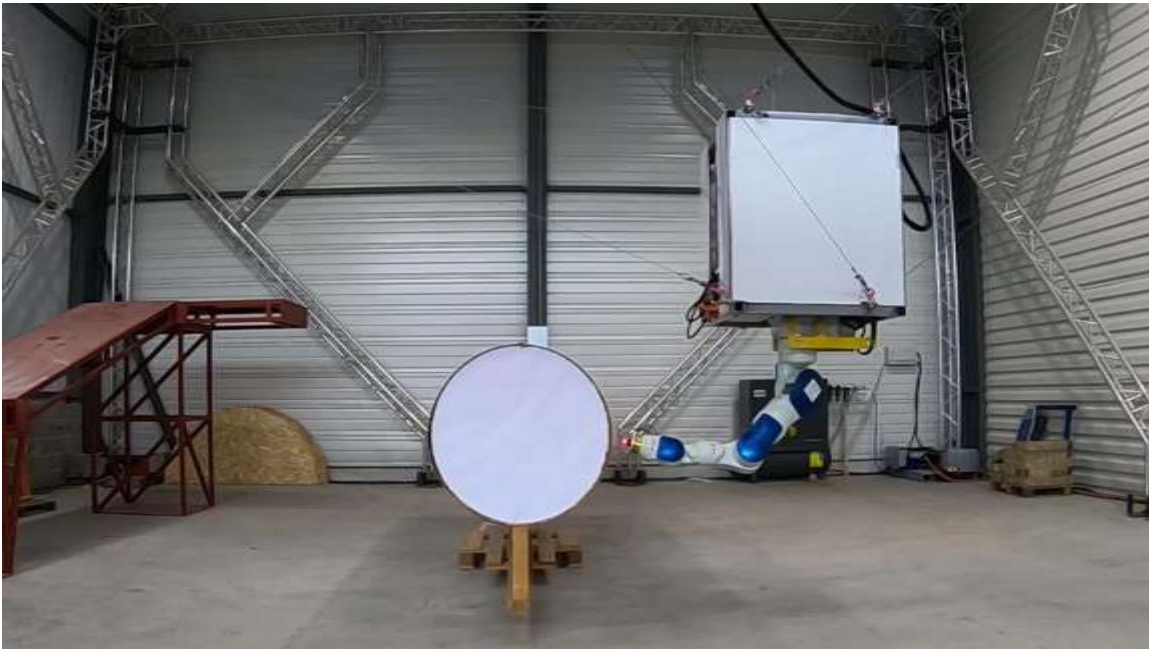
Robot à câbles CoGiRo portant un bras robotique Yaskawa – Projet ANR DexterWide
